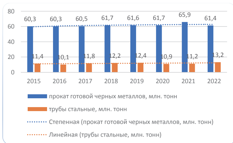
Рисунок 2 – Производство проката черных металлов и стальных труб, 2015-2022 гг., млн. тонн*
