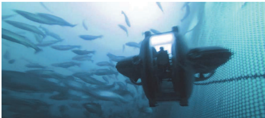
Рисунок 6 – Deep Trekker - подводный аппарат с дистанционным управлением (ROV)
