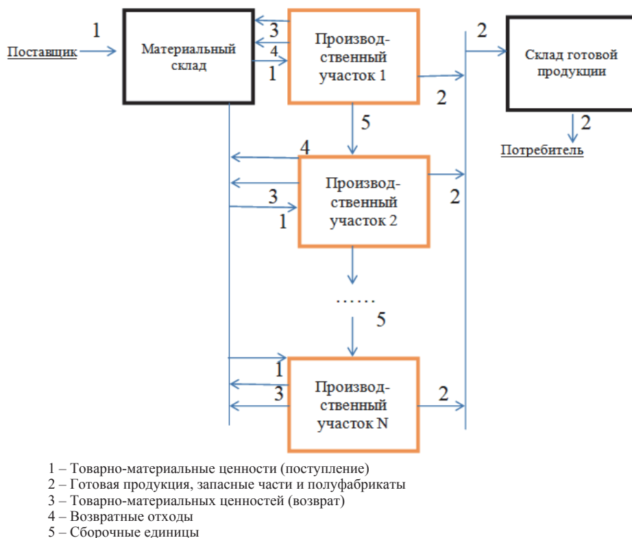
Рисунок 1 – Агрегированная схема внутреннего перемещения грузов на исследуемых предприятиях Источник: исследование автора
